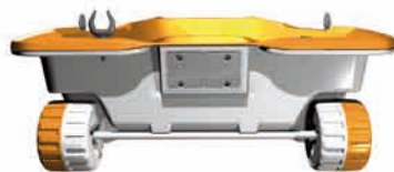
Sur le BIC 245, les roues sont intégrées dans le dessin de la carène
